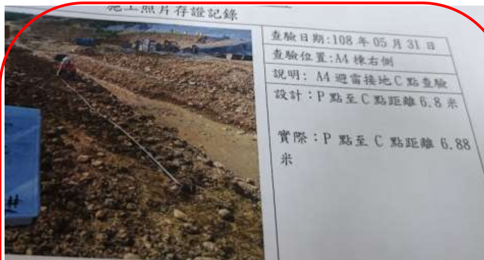
正確保留 E-P-C 電極間的距離量測資料
